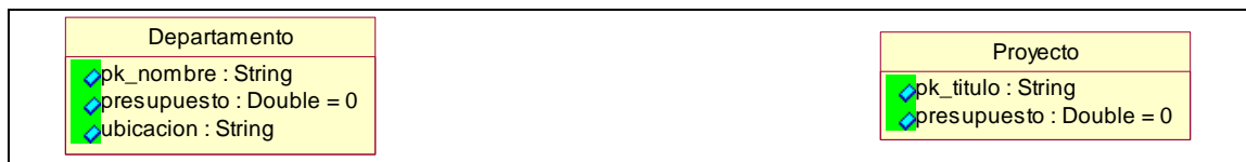
Figura 3-7. Clases generadas a partir de las tablas Departamento y Proyecto del esquema BDOR.
